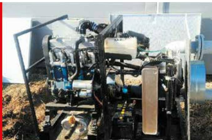
Газовая насосная станция на базе двигателя внутреннего сгорания и центробежного консольного насоса предназначена для перекачивания воды и других жидкостей, имеющих сходные с водой свойства по вязкости и химической активности, с температурой от -10 до 105°C. Применяется в жилищной коммунальной сфере для циркуляции технической воды в системе отопления и водоснабжения.
